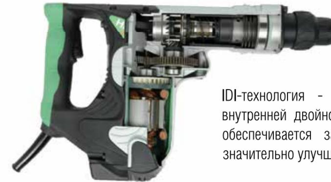
Линейку отбойных молотков Hitachi объединяет запатентованная IDI-технология, которая не только улучшила внешний вид изделий, но и заметно увеличила их ресурс. IDI-технология - это конструкция алюминиевого корпуса с внутренней двойной изоляцией из полиамида. Благодаря этому обеспечивается защита металлических элементов корпуса и значительно улучшаются изоляционные характеристики.
