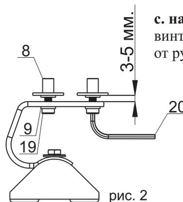
**с.** наживите крепежные пластины[8], используя винты[19] и шайбы[9] с помощью ключа[20] или от руки, оставив зазор в 3-5 мм (см. рис. 2).
