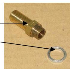
F: снять с штуцеров шайбы. Насадить шайбы на новые штуцеры и закрепить.
