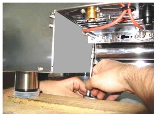
D: Снять левую горелку, затем правую.
