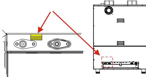
Подключение выполняется с помощью переходника и прокладок, соответствующих типу газа (см. технические данные).
