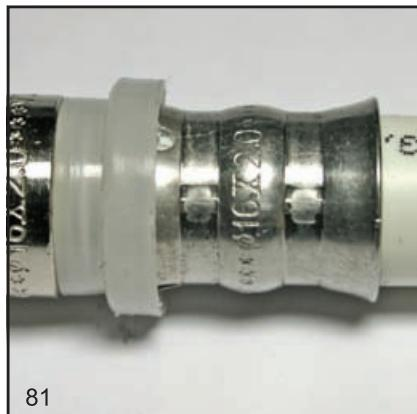
Для выправления «зашипов», инструмент поворачивается вокруг оси трубы на 15-90 градусов и опрессовка повторяется. После этого гильза фитинга не должна иметь ярко выраженных «зашипов».
