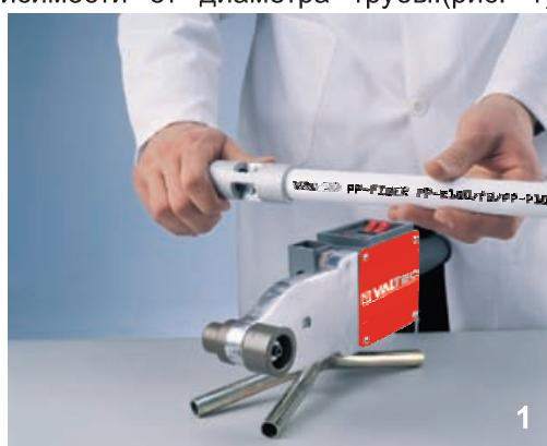
При правильной калибровке торец трубы должен быть строго перпендикулярен длине трубы и при смотре, иметь круглую канавку точно по центру стенки трубы, глубиной 1-2 мм.
