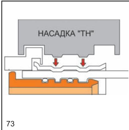
Пресс-вкладыши для фитингов **VTm200** должны иметь профиль типа «ТН». Использование насадок другого профиля **НЕ ДОПУСКАЕТСЯ!**
