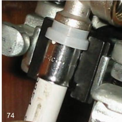
Инструмент заводится на фитинг таким образом, чтобы буртик гильзы вошел в соответствующее углубление пресс-насадки
