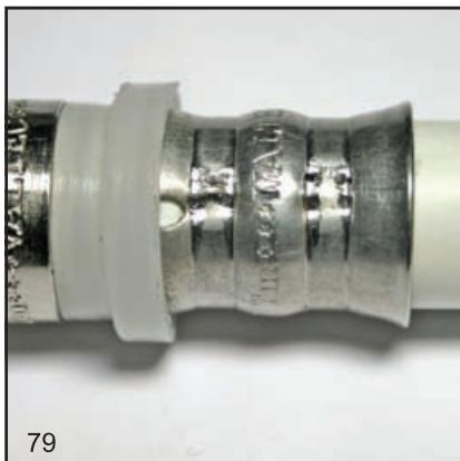
При первичной опрессовке на гильзе появляются два параллельных углубления и характерные «зашипы» в местах сопряжения пресснасадок
