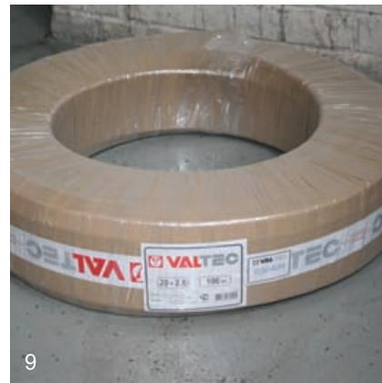
Если бухта металлополимерной трубы доставлена в помещение с мороза, ей дается возможность вылежаться в течение 5 часов при температуре не менее 10°C
