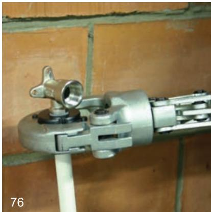
После фиксации инструмента обойма закрывается до защелкивания замка
