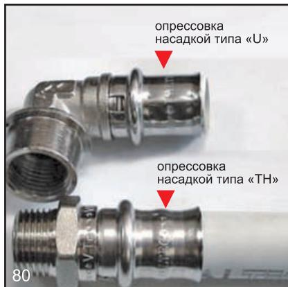
В случае использования насадок другого профиля, рисунок деформации гильзы – иной
